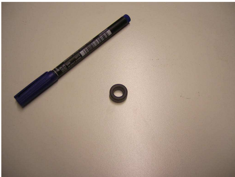
Fig. 1: il piccolo toroide senza avvolgimenti
